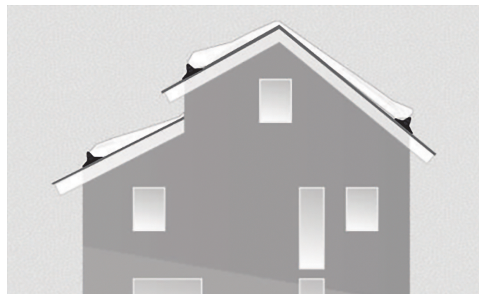
Снегозадержатели устанавливают на каждый скат многоуровневых крыш.
