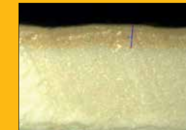
Сайдинг Дёке под микроскопом 200x
